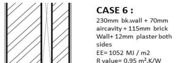
Fig. 7 : Brick + Air Cavity + Brick
